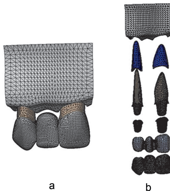
Figura 2. a. Enmallado del modelo de una PPF de tres unidades anterior b. enmallado de cada componente
