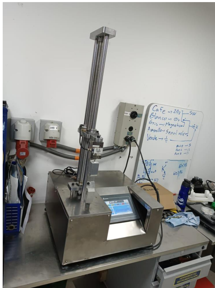
Imagen 18. Tornillo sin fin y barras de soporte.
