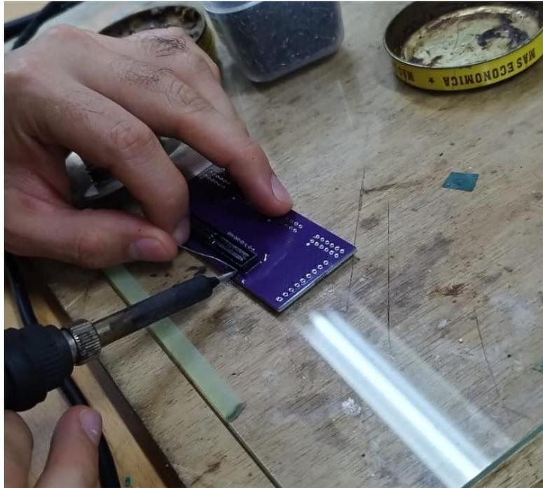
Ilustración 24 Ensamblaje del conector QSH-060-01-L-D-A de montaje superficial
