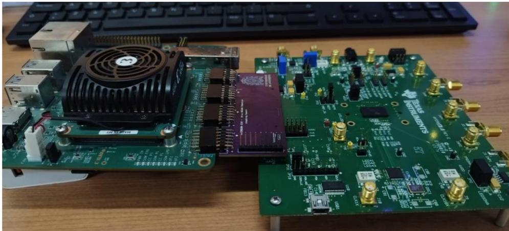
Ilustración 25 Conexión de la primera versión de la tarjeta de acople con el AFE5808AEVM y la Kria KR260
