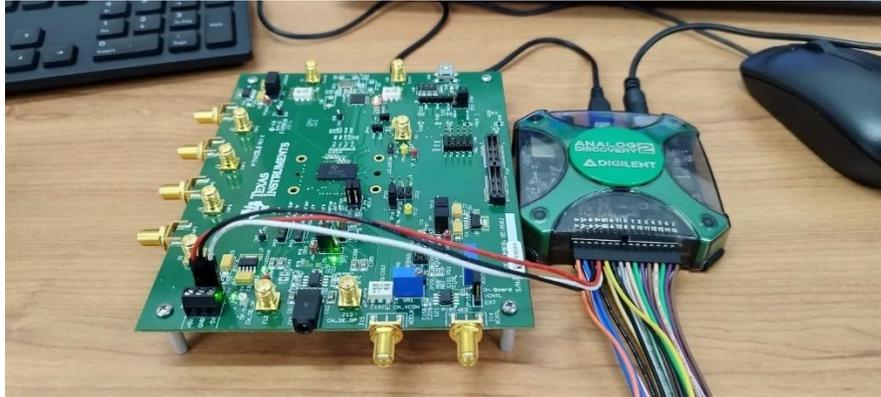
Ilustración 13 Correcta alimentación para el encendido del AFE5808A EVM
