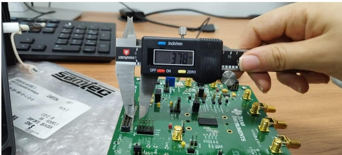
Ilustración 20 Mediciones para las restricciones mecánicas de la tarjeta de acople
