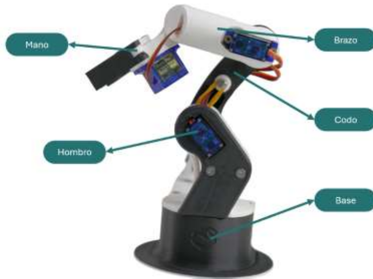
Fig 12. Brazo robótico con sus partes.
