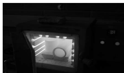
Figura 3. Incandescencia del tubo de SiC durante su tratamiento térmico
