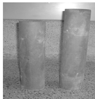
Figura 4. Tubos de carburo de silicio obtenidos
