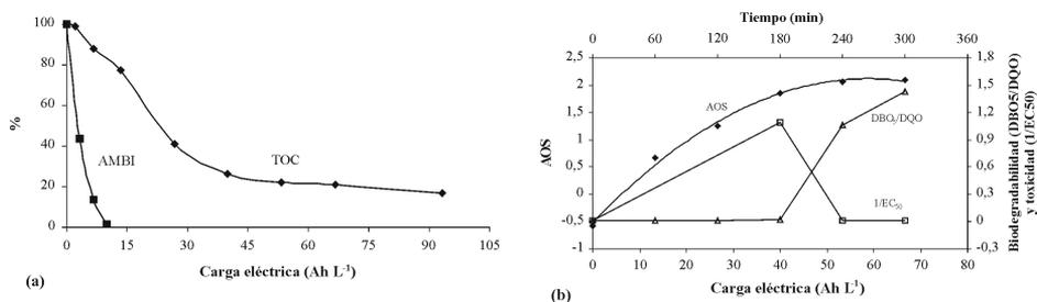
**Figura 3.** Tratamiento electroquímico de aguas residuales que contienen 5-amino-6-metil-2-benzimidazolón (AMBI). Condiciones: 5,0 mmol l<sup>-1</sup> de AMBI, 25 mA cm<sup>-2</sup> y 70 °C. (a) Concentración relativa (expresada en %) del compuesto inicial y del carbono orgánico total (COT). (b) Evolución de la toxicidad, biodegradabilidad y del estado de oxidación promedio (AOS).
