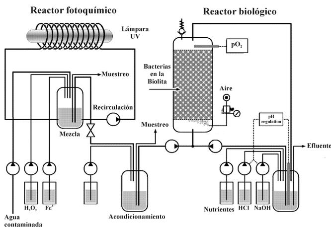
Figura 2. Diseño esquemático del reactor acoplado fotoquímico-biológico.
