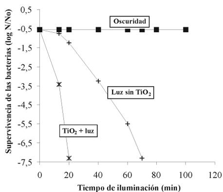
**Figura 4.** Inactivación de *E. coli* por luz en presencia y ausencia de  $TiO_2$ . Experimentos de control en la oscuridad con y sin  $TiO_2$ . Concentraciones iniciales:  $10^7$  UFC/ml y  $1\text{ gl}^{-1}$  de  $TiO_2$ .
