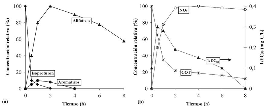
**Figura 6.** (a) Concentración relativa (expresada en %) del compuesto inicial, intermediarios aromáticos y alifáticos observados durante el fototratamiento de una solución de isotroturon (0,21 mM) con 25 mM de  $H_2O_2$  y 1 mM  $Fe^{3+}$ . (b) evolución del COT y del  $NO_3^-$  durante el fototratamiento en función del tiempo. La evolución de la toxicidad se muestra a la derecha de los ejes.
