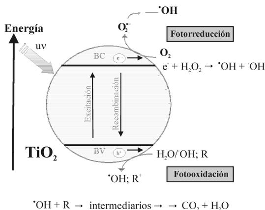
Figura 1. Esquema del proceso fotocatalítico sobre una partícula semiconductor de  $\text{TiO}_2$ .
