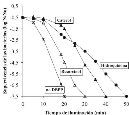
**Figura 5.** Inactivación fotocatalítica de *E. coli* en presencia de catecol, hidroquinona y resorcinol. Concentraciones iniciales:  $10^7$  UFC/ml, 2 mM de DBPP y  $1 \text{ g l}^{-1}$  de  $\text{TiO}_2$ .
