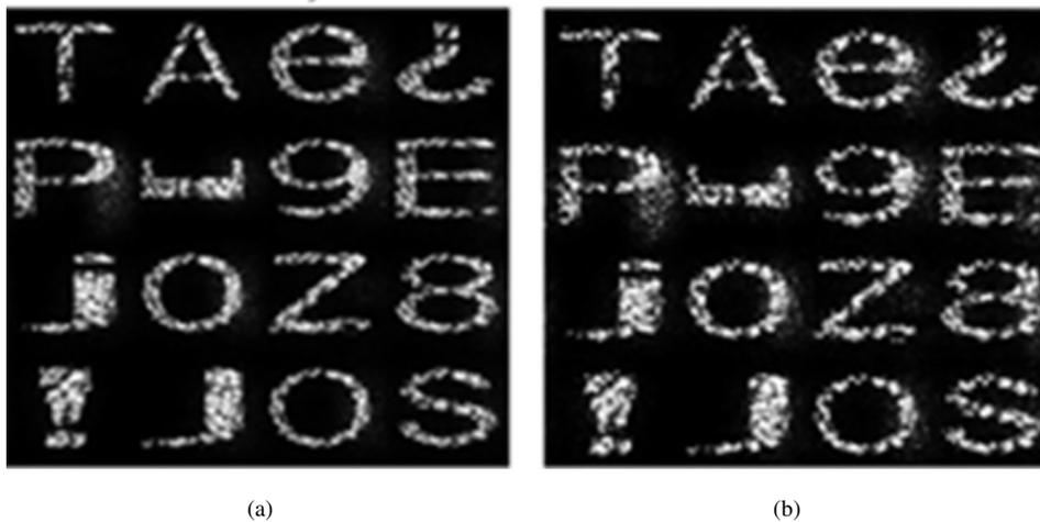
**Figura 4.4:** Recuperación: (a) sin el proceso de escalado sobre el multiplexado y (b) con escalado óptico de  $M=0.5$  sobre el multiplexado.
