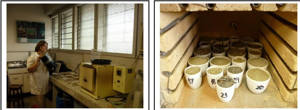
**Figura 4.** Fotografías de las muestras de sedimentos luego de ser secadas y tamizadas y determinación de materia orgánica, ubicadas en la mufla, antes de la calcinación.
