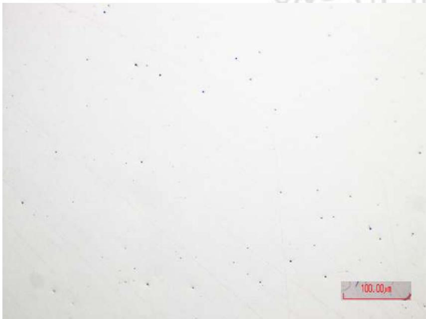
**Figura 7.** Micrografía materia prima acero AISI 1006 sin ataque.
