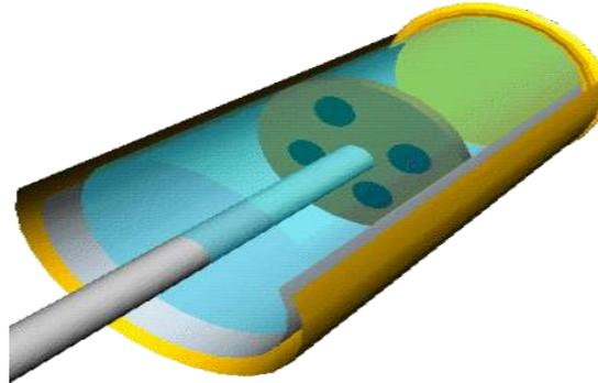
Si un coche no tuviera suspensión (es decir, si el chasis estuviera unido rígidamente al eje de las ruedas), cada hueco o irregularidad en el suelo se notaría como un golpe en el interior del vehículo lo cual, además de incómodo, pone en peligro la integridad de los pasajeros y / o carga. Por otro lado, si la suspensión consistiera simplemente en un resorte casi sin rozamiento, cada hueco produciría oscilaciones en el coche, incluso mucho después de haber superado el hueco.
