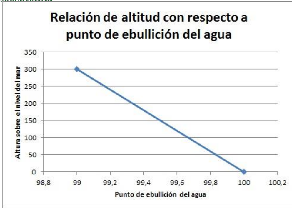
Imagen 3: Relación de altura para el hipsómetro
