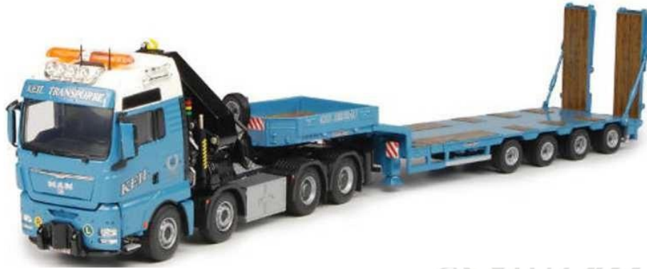
Fig 20. Grúa cama baja.
