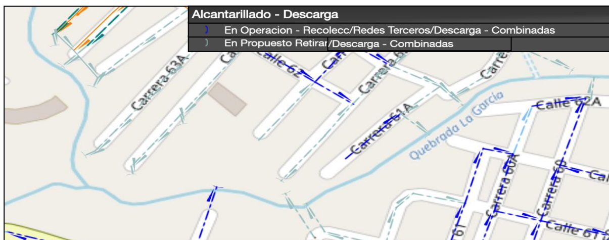
Figura 10. Descargas del sistema de alcantarillado directamente sobre la quebrada La García. Empresas Públicas de Medellín E.S.P. (2020). Mapa de redes de acueducto y alcantarillado. Recuperado de Geoportal EPM website: https://grupoepm.maps.arcgis.com/apps/webappviewer/index.html?id=591f5234f4a544e38bfef36d564320e0
