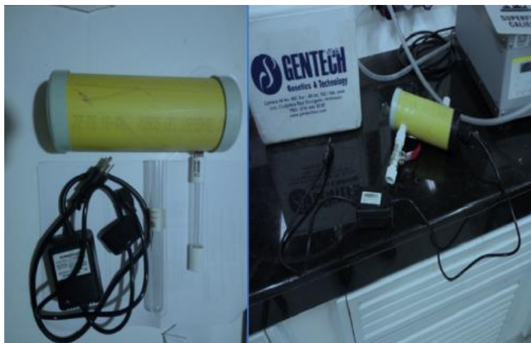
Figura 19. Lámpara UV utilizada en experimentación. Tomado de (Lugo-Arias et al., 2020).
