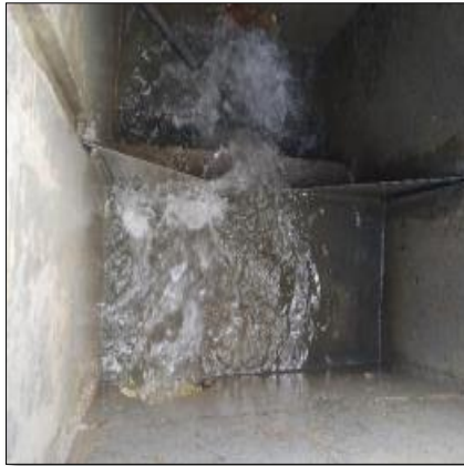
Foto 20. Vertedero triangular con un ángulo de 90 grados Tomada por: María Camila Gómez
