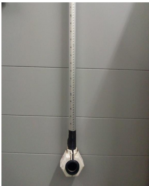
Fotografía 7. Correntómetro Global Water Flow Probe
