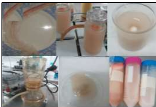
Imagen 13. Etapas del proceso de obtención de colágeno a partir de EDT
