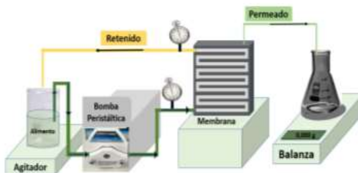
Figura 4. Diagrama del sistema de filtración tangencial
