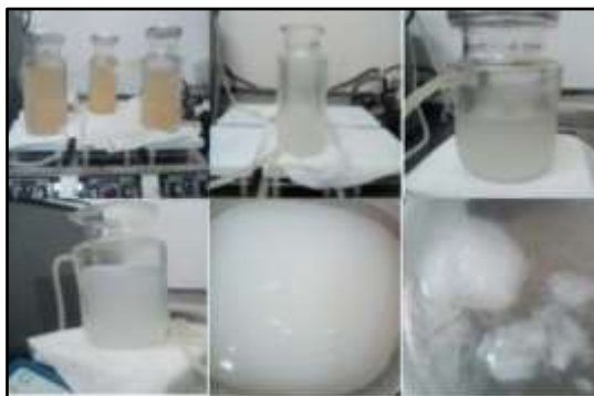
Imagen 12. Etapas del proceso de obtención de colágeno a partir de ETR
