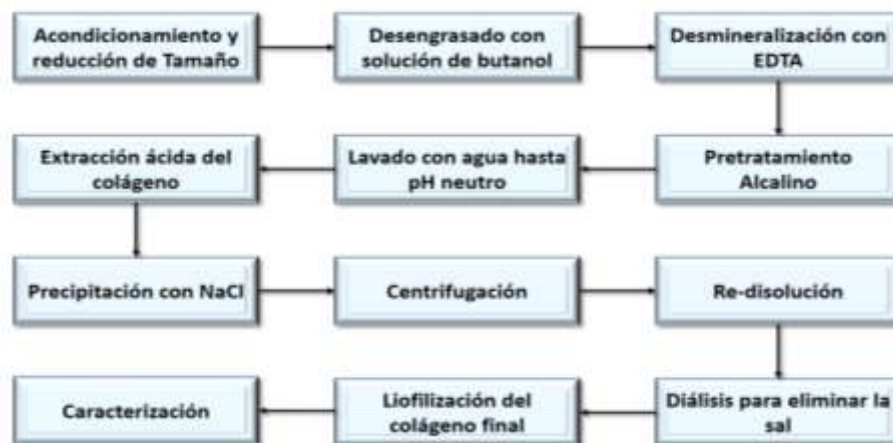
Figura 3. Diagrama de Flujo del proceso de extracción de colágeno ácido soluble a partir de subproductos de pescado.
