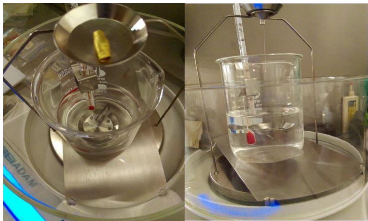
Figura 30. Proceso para determinar la densidad de los objetos.
