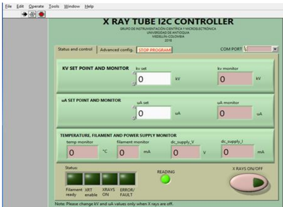
Figura 23. Esquema gráfico del Software elaborado para manipular el tubo de rayos x, se muestran sus principales ventanas características.
