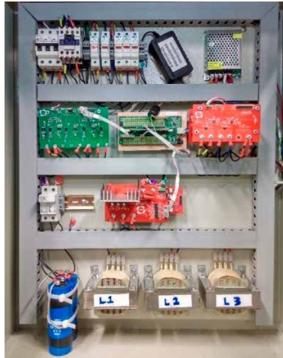
Figura 8. D-STATCOM utilizado para el diseño del control.
