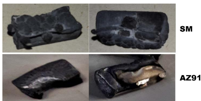
Figura 22. Muestras sin molienda y AZ91 con molienda a 600, 900 rpm después de HIP a 600°C
