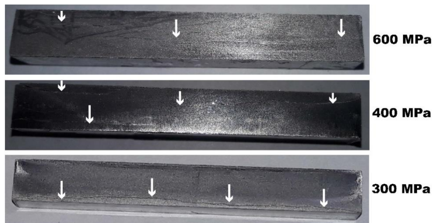
Figura 31. Muestras AZ91, compactadas a 600 MPa, 400 MPa y 300 MPa con fracturas
