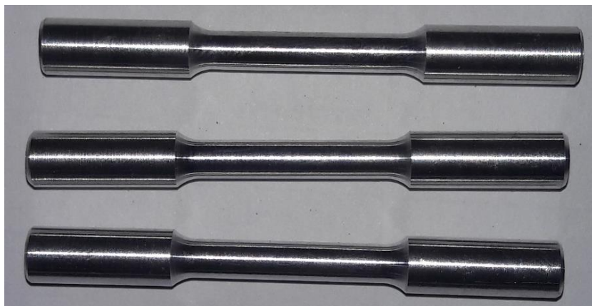
Figura 43. Muestras AZ maquinadas para ensayo de tracción
