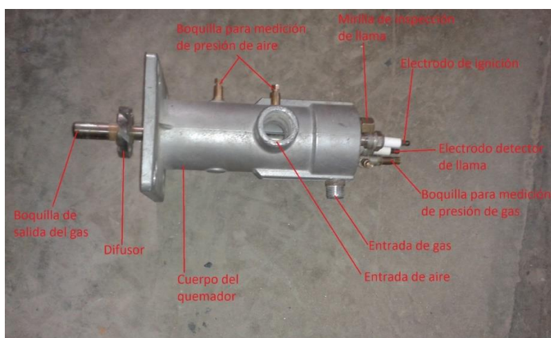
Figura 15. Quemador de alta velocidad TCK® (Realización propia).
