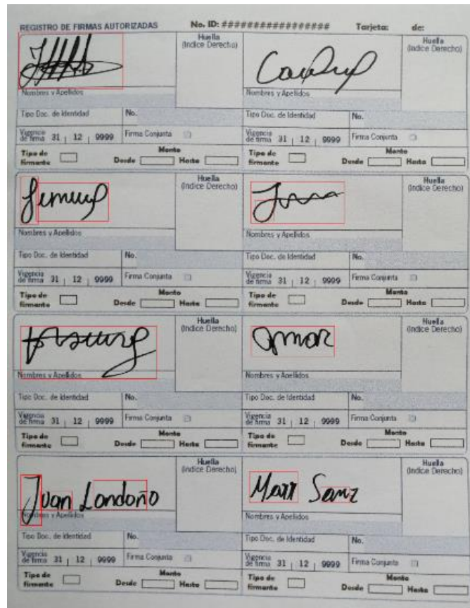
Figura 5.2. Resultado de segmentación por color con OpenCV. Imagen propia. (Datos personales ficticios)
