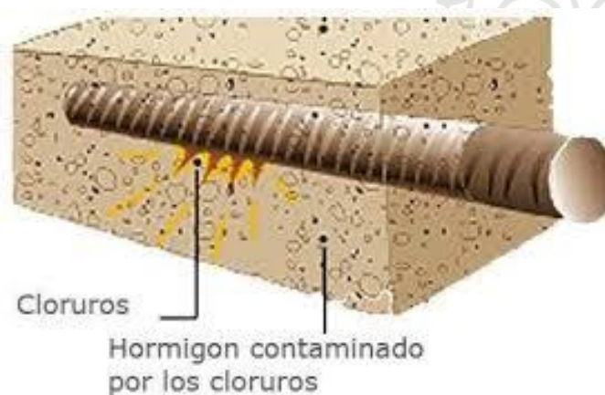
Figura 30. Representación de la corrosión. Tomado de: (MÁS QUE INGENIERÍA, n.d.)
