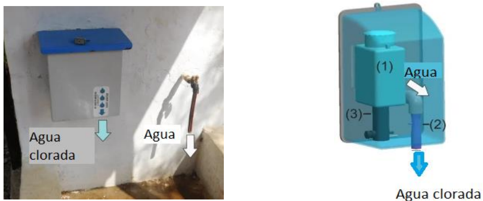
Figura 11. Dosificador lineal de cloro líquido. (1) tanque de almacenamiento de cloro de 1 L; (2) válvula de manguito de la fuente; (3) tanque de flotación. Fuente: (Powers et al., 2021)
