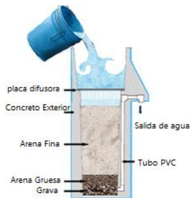
Figura 2. Filtro de bioarena implementado en algunos hogares en Haití en el año 2006. Fuente: (Duque et al., 2006)
