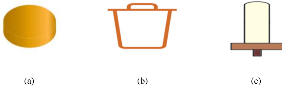
Figura 6. Filtro de membrana cerámica. Panel (a) membrana plana. Panel (b) olla cerámica. Panel (c) Vela. Fuente: Goswami & Pµgazhenthī, (2020).
