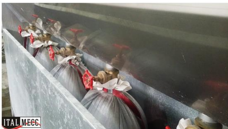
Imagen 9: deshidratador de lodo Italmecce
