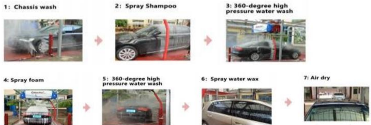
Imagen 4: Proceso del funcionamiento del túnel de lavado.
