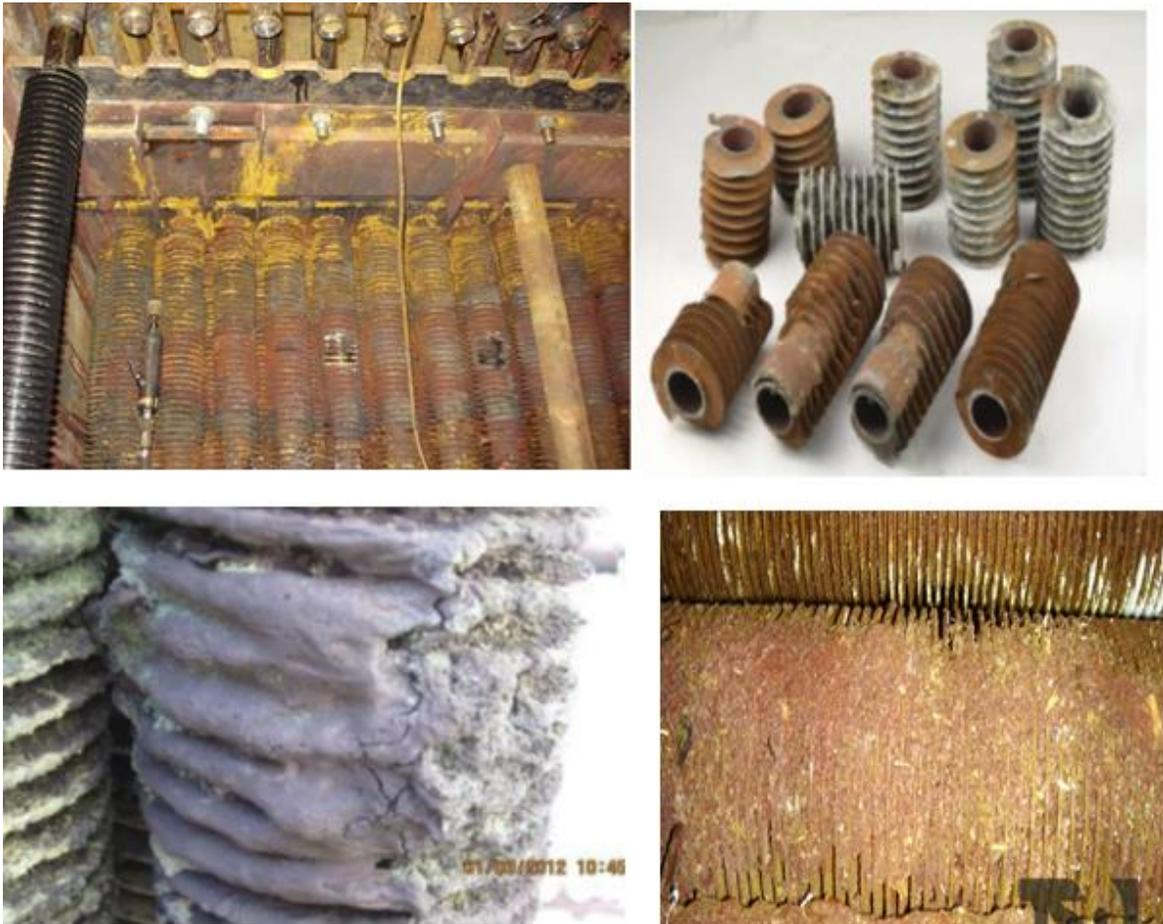
**Figura 22. Ensuciamiento y corrosión de tubos aletados en economizadores de calderas. Tomado de [http://www.gard.no/Content/24317612/EconomizerProblems\\_LNGCarriers.PDF](http://www.gard.no/Content/24317612/EconomizerProblems_LNGCarriers.PDF)**
