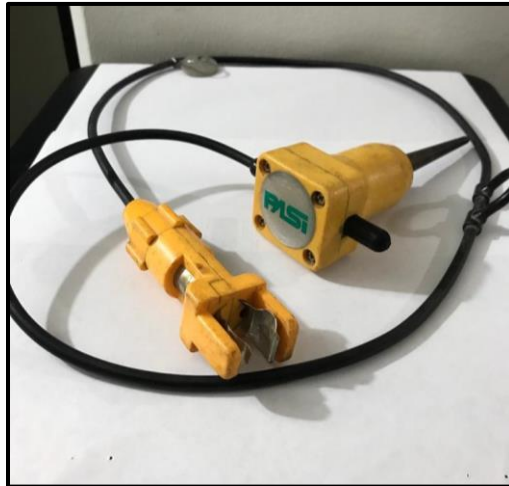
Figura 7. Geófono de 4.5Hz. Elaboración propia.
