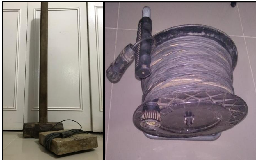
Figura 10. Martillo de 25 lb, placa y cable del trigger. Elaboración propia.
