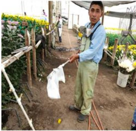
**Imagen 5:** Toma de aforos de las lanzas. Fuente: Tomada por el autor del trabajo, (2021). La Ceja Antioquia.
