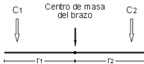
Figura 18. Análisis de las fuerzas aplicadas al brazo
