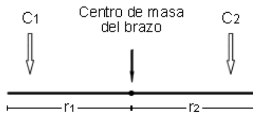
Figura 14. Análisis de las fuerzas aplicadas al brazo
