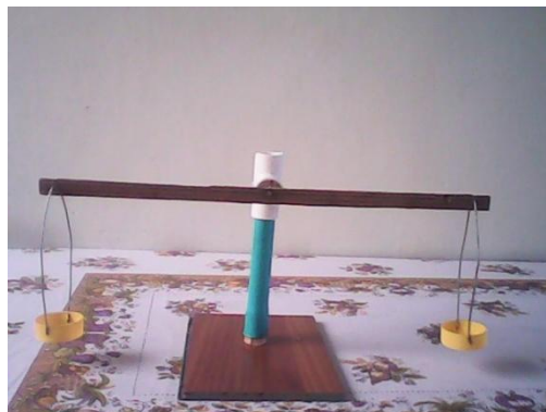
Figura 27 a: cuando el punto de apoyo está en su centro de masa, se observa que el instrumento no hay movimiento.
