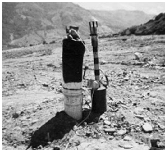
Figura 2 Medición del caudal de biogás en un pozo de desfogue en el RSCR
