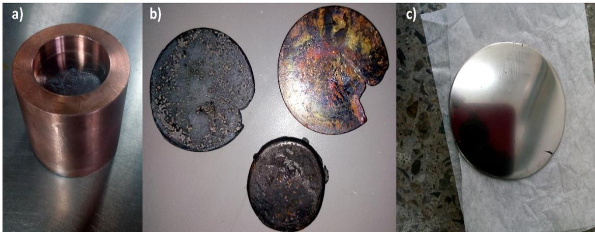
**Fig. 79** etapas para la fabricación del blanco aleación  $(\text{Fe}_{63}\text{Ni}_{37})_{89}\text{B}_{11}$ , a) coquilla (molde) donde se realiza el vaciado del material fundido, b) probetas de las aleaciones  $(\text{Fe}_{63}\text{Ni}_{37})_{89}\text{B}_{11}$  y  $(\text{Fe}_{63}\text{Cu}_{37})_{89}\text{B}_4$  c) blanco de aleación  $(\text{Fe}_{63}\text{Ni}_{37})_{89}\text{B}_{11}$  pulida lista para ubicar en el cañón del sistema sputtering.
