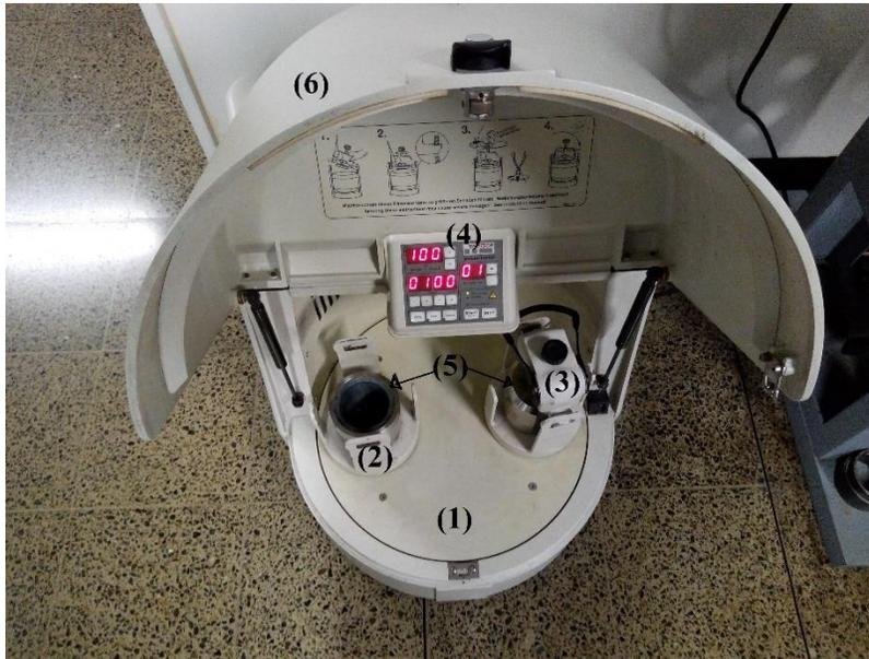
**Fig.22** Molino planetario Fritsch Pulverisette empleado para procesos de MM a bajas energías (~400 rpm) (1) bandeja principal del molino, (2) porta jarros, (3) seguro, (4) panel de control, (5) y (6) tapa de seguridad
