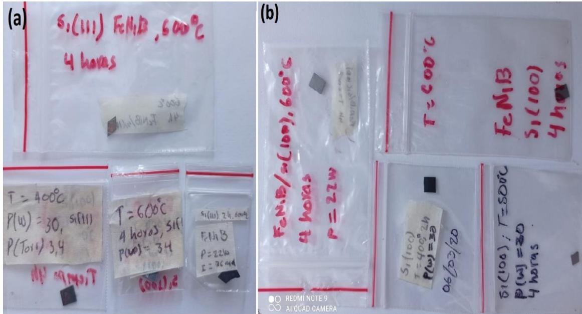
**Fig. 29** películas FeNiB/Si(111) y FeNiB/Si(100) con tiempos de crecimiento desde 2 a 4 horas
