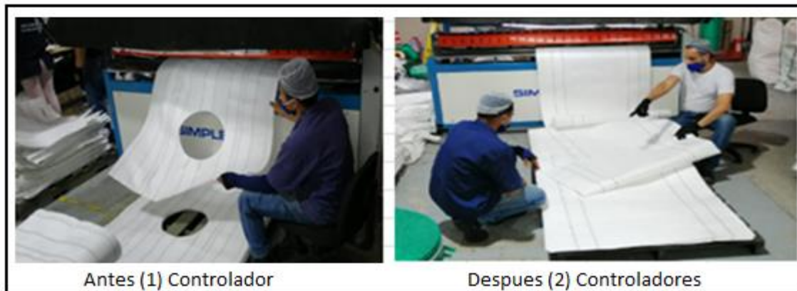
Ilustración 7: Métodos de revisión de la tela de Big Bags. Fuente: Manufactura SAS
