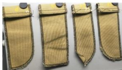
Imagen 12: Prueba Dark Khaky de muestras de aceite con residuos de polvo.
