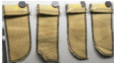
Imagen 11: Prueba Dark Khaky de muestras de aceite limpio.
