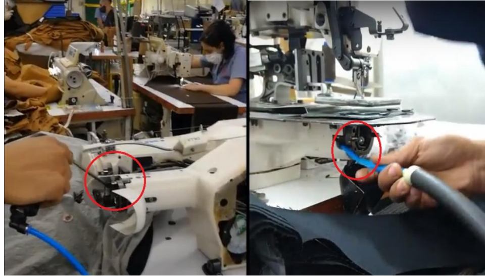
Fig. 2: Método de limpieza general con insuflación vs aspersion en presilladora.
