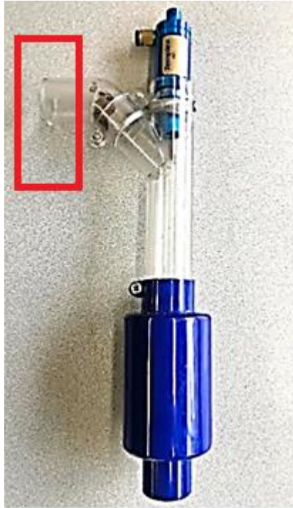
Fig. 6: Lugar específico de mejora del tubo Venturi para el sistema de aspersión de residuos
