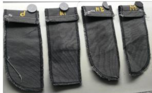
Imagen 7: Prueba Gravel de muestras de aceite limpio.
