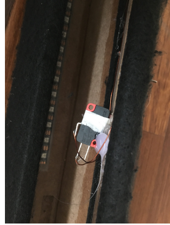
Interior de columna: micro switch, leds neopixels, cobre como conductor
