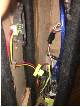
Interior de la columna: arduino, power bank, sensor de movimiento.
