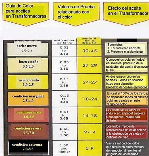
Fig. 1. Guía de color para aceites en transformadores, con el posible efecto del aceite en el transformador.[2]
