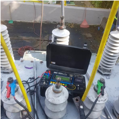
Fig. 21. Prueba de resistencia de devanados.
