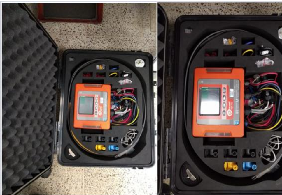
Figura 14. Instrumento de medición (analizador de redes SONEL PQM-702[Fuente propia].
