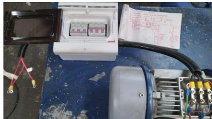
Imagen 25 - Inversión de giro de motor
