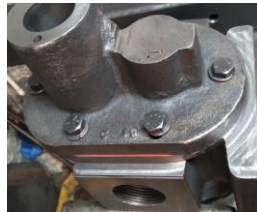
Imagen 21 – Tapas de fundición Nodular.
