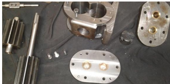
Imagen 35 - Pre - Ensamble y revisión de las partes fabricadas.
