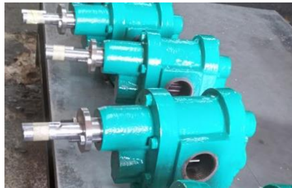
Imagen 28 - Eje de entrada Bombas Piñones Imrecol SAS
