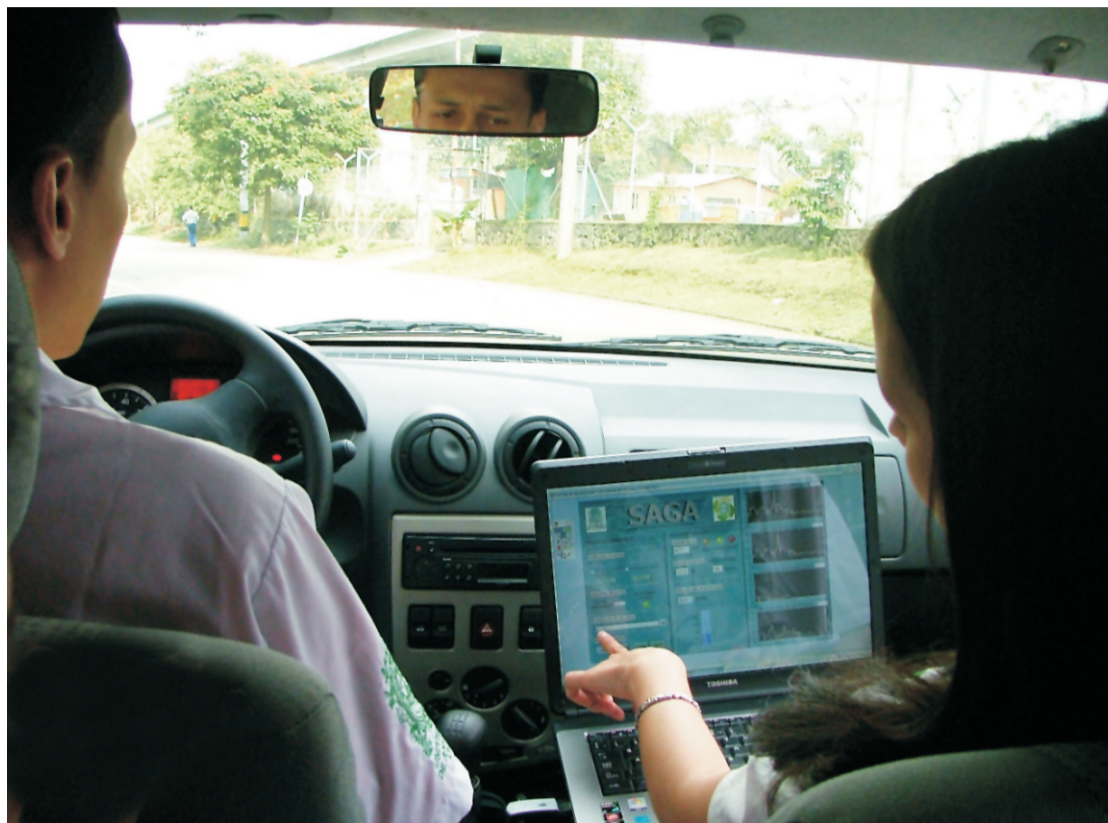
Pruebas con el Sistema Saga en el vehículo instrumentado por ingenieros de la Facultad de Ingeniería de la U. de A.
