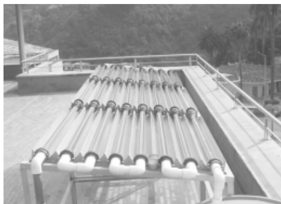
Foto 1. Colector solar cilindro parabólico empleado para el tratamiento del agua coloreada con Rojo Amaranto.
