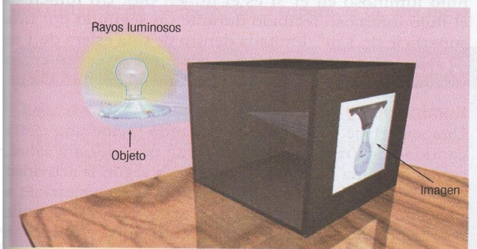
Figura 1. Cámara oscura con la cual se pretende demostrar que la luz se propaga en línea recta. Física General, Pérez.
