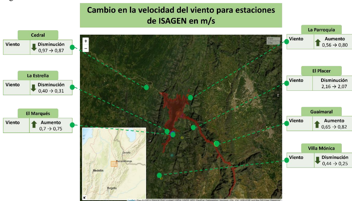
Figura 3.12. Cambio en la velocidad del viento en (m/s) para las estaciones N/I en el área de influencia del embalse entre el periodo antes y después del llenado del embalse. Las flechas representan un cambio estadísticamente significativo
