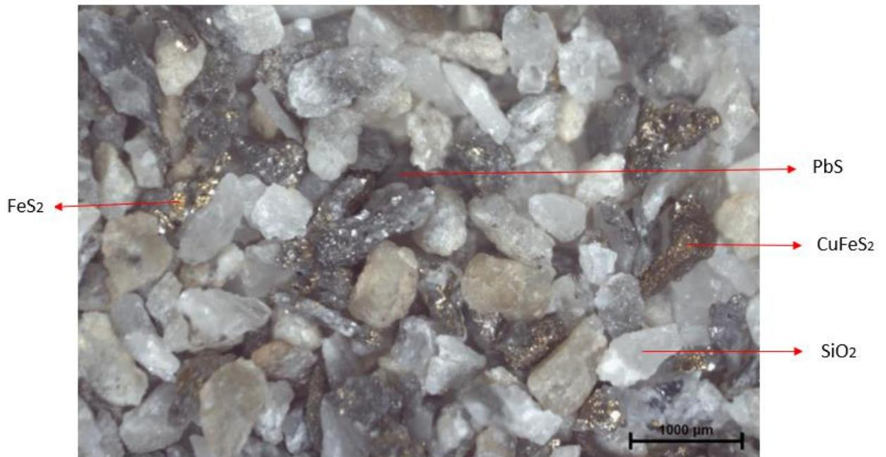
Fig. 13. Especies minerales identificadas en el microscopio estereoscópico.
