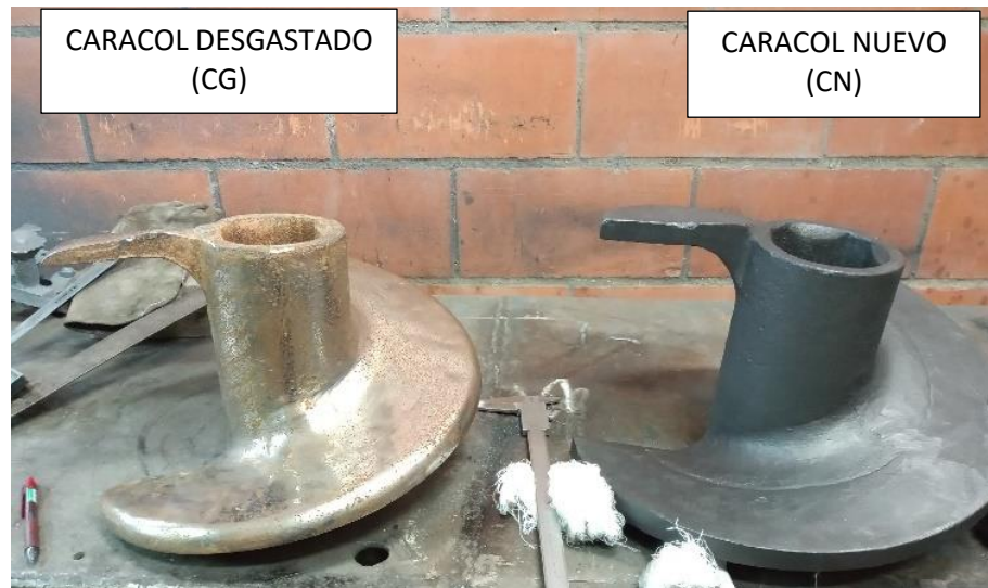
Fig. 11. Muestra de caracol medio 057: Izq. caracol desgastado (CG), Dcha. caracol nuevo (CN)
