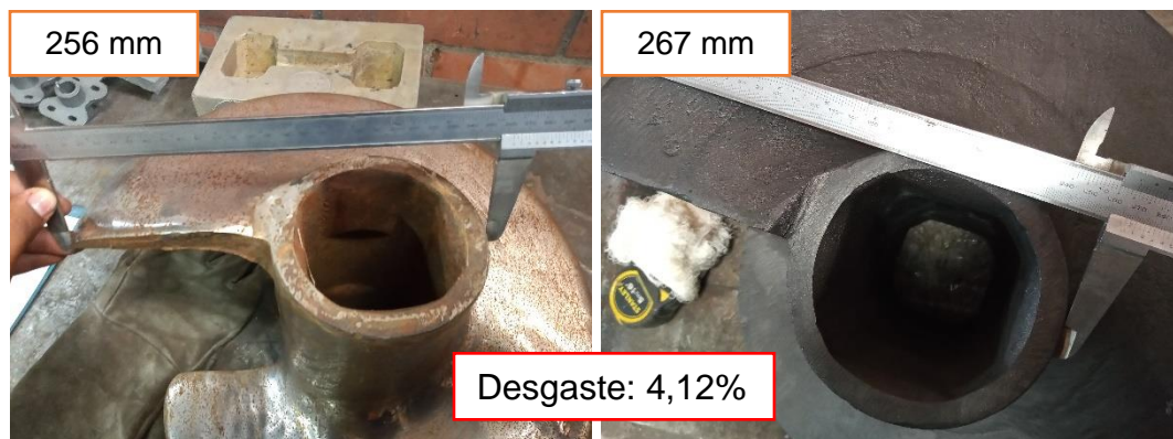
Fig. 12. Medición de aletas: Izq. caracol desgastado (CG), Dcha. caracol nuevo (CN)
