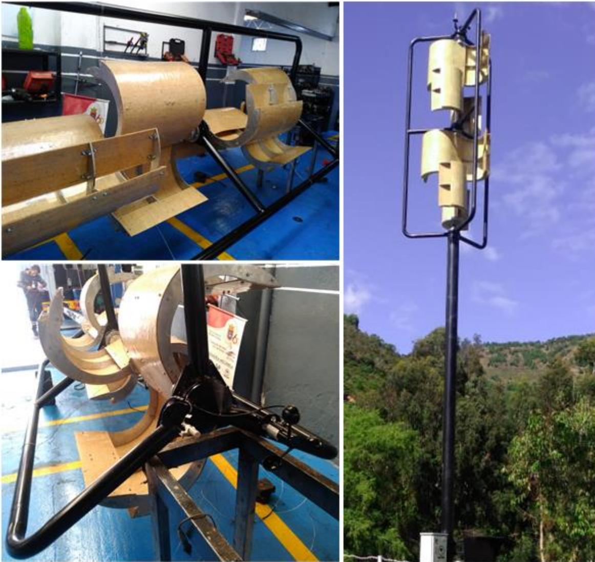
**Figura 6-30. Aerogenerador con álabes de material Epoxi/Fique.**
