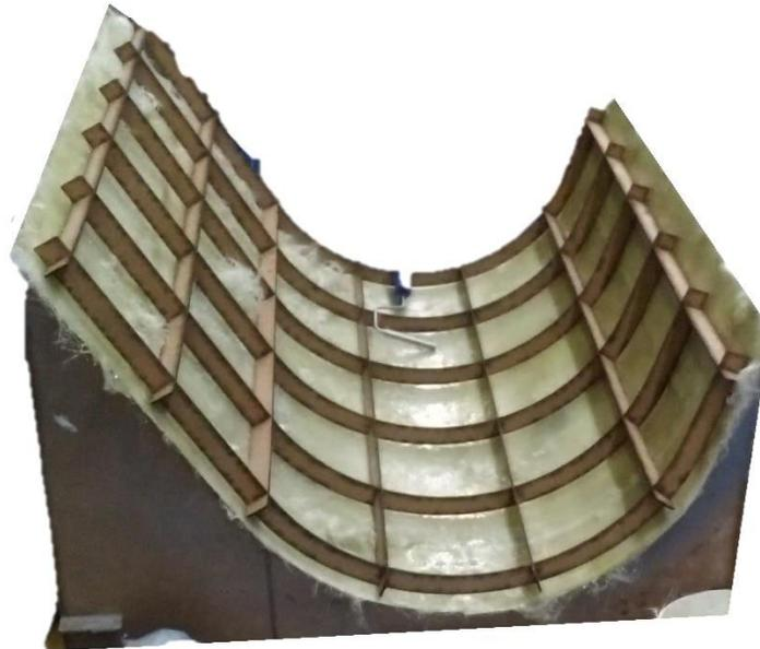
**Figura 6-25. Adición de refuerzo estructural.**
