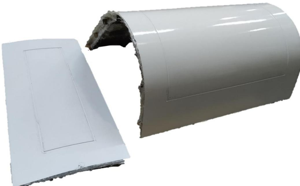
**Figura 6-26. Molde de álabes para la fabricación por infusión en vacío.**
