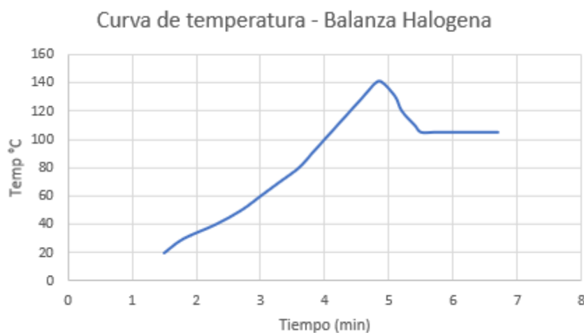
Figura 3. Comportamiento de la temperatura en la balanza halógena OHAUS MB45
