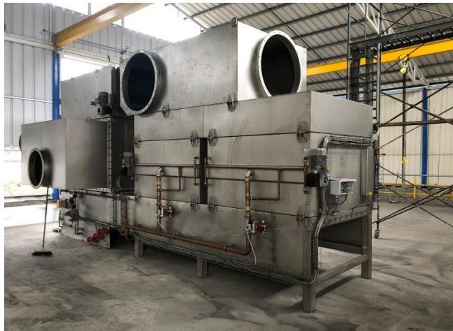
Figura 4: Equipo KMA de filtración de aire ensamblada mecánicamente.
