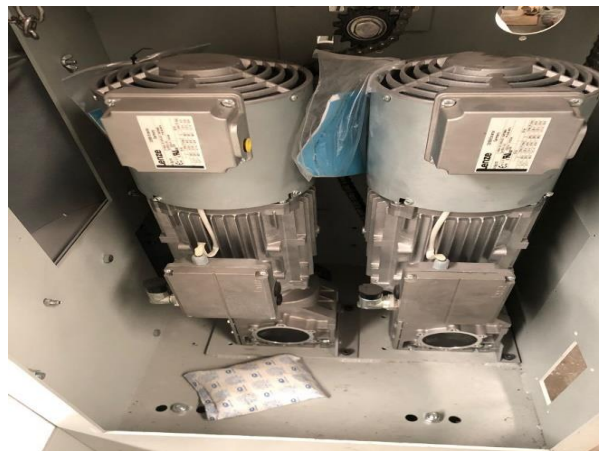
Figura 24: Motores Zona de abridores.
