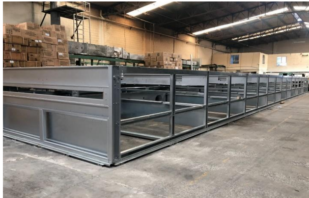
Figura 21: Línea de hornos en proceso de ensamble.
