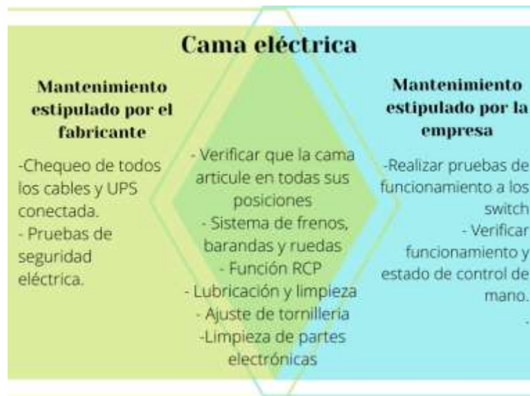
Figura 3. Comparación de rutinas de mantenimiento para la cama eléctrica.
