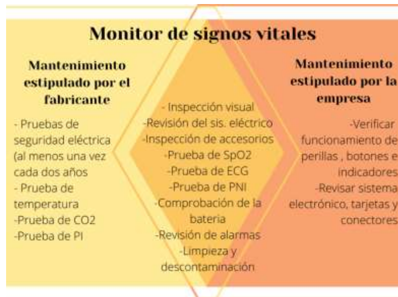
Figura 2. Comparación de rutinas de mantenimiento para un monitor de signos vitales
