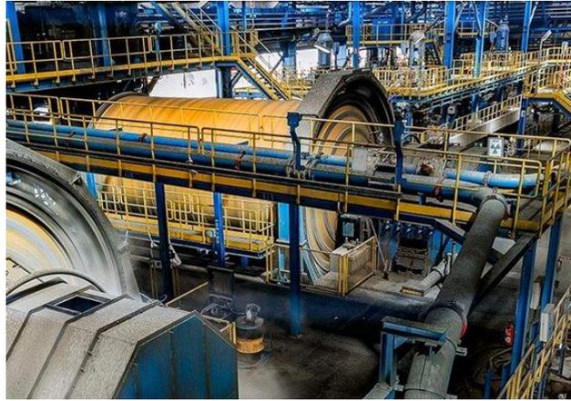
Figura 3. Molino de bola para beneficio de minerales. Fuente. (mogroup, 2022)
