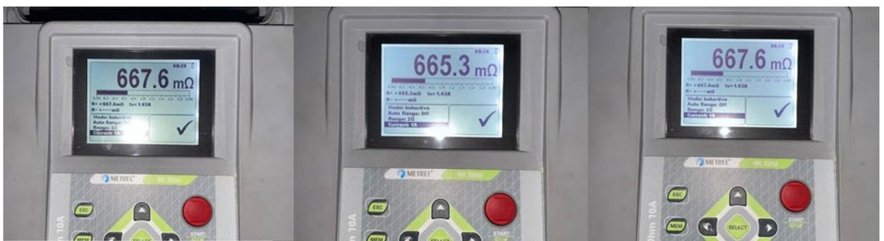
Fig. 11. Resistencia devanado primario.
