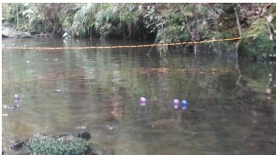
Figura 20. Aforo con Flotadores
