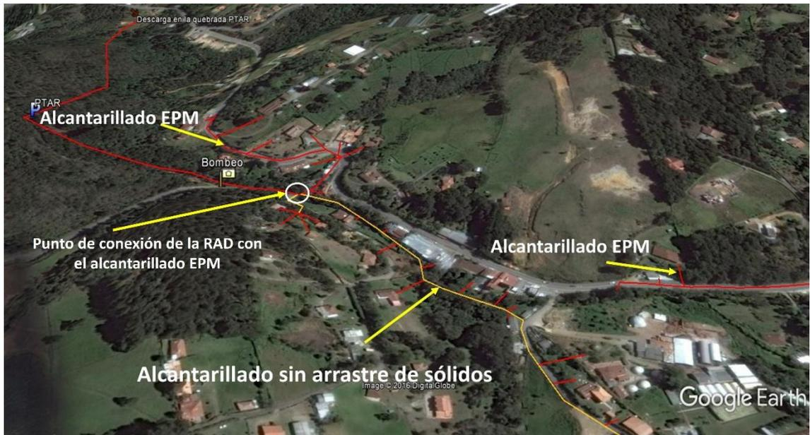
**Figura 57. Red de alcantarillado público de EPM y alcantarillado sin arrastre de sólidos**
