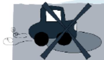
No pasemos carros por encima del tanque porque las tapas no están diseñadas para resistir tanto peso.
