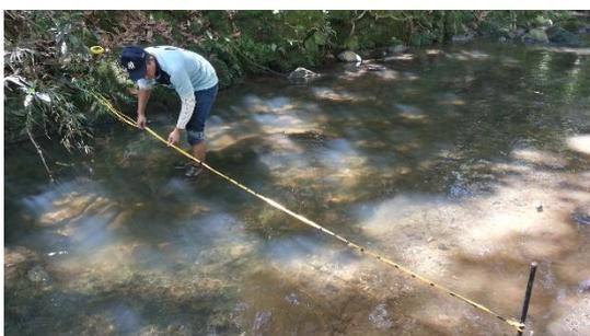
Figura 15. Medición sección transversal.
